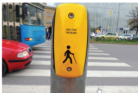
Slika 6. Semaforska signalizacija za slijepe osobe. Izvor: [8]
