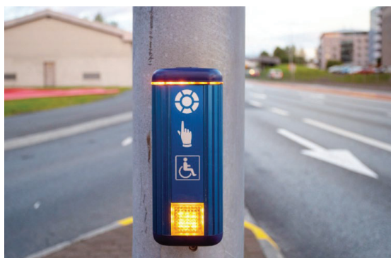
Slika 20. Taster na semaforu za prelazak invalida. Kreacija: autor.
