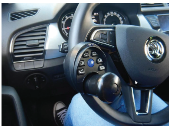
Slika 3. Prepravljene komande za jednoručno upravljanje vozilom. Izvor: [7]
