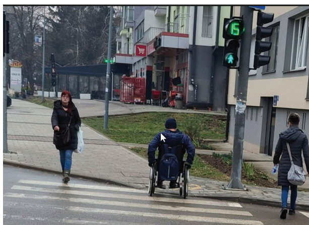
Slika 19. Semafor sa odbrojavanjem vremena. Izvor: autor.
