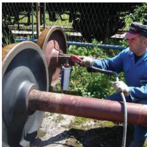
Slika. 4.10. Proces nanošenja dvokomponentne gumirajuće mase na disku točka
