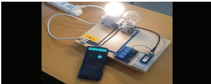
Slika 3. Upravljanje rasvjetom pomoću mobilnog telefona Izvor: https://i.ytimg.com/vi/5dKPJOYRKfU/maxresdefault.jpg
