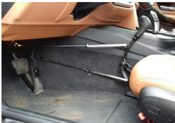
Slika 2. Prepravljeno vozilo –nožne na ručne komande. Izvor: [6]
