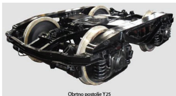
Slika 4. 1. Obrtno postolje (trčaći stroj) željezničkog vozila
