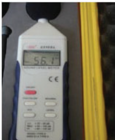
Slika. 4.12. Mjerni instrument bukomjer tipa SEW 2310 SL serije 9411061
