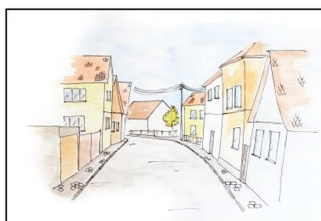
Ausgangssituation: beidseitig unzureichende Gehwegbreiten
