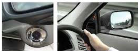
Slika 37. Smeštaj kamere i signalnog svetla kamere
