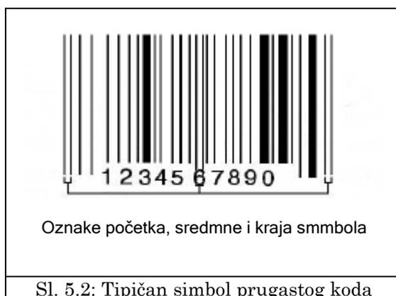
Svetlosno pero je jedna vrsta skenera koji se sastoji od emitora svetlosti i detektora reflektovanog zraka. Prelaženjem svetlosnim perom preko oznaka prugastog koda detektuje se niz signala koji odgovaraju tamnim i belim vertikalnim crtama. Dekodiranjem ovih signala dobijaju se odgovarajući numerički podaci.
